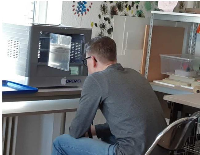
Heute wurden zuvor im 3D konstruierte Bauteile wie Flächenverbinder und Leitwerksaufnahmen gedruckt. Leider sind die Flächenverbinder zum Einstecken in die CFK Rohre nicht ausreichend steif, wir arbeiten an einer alternativen Lösung.
