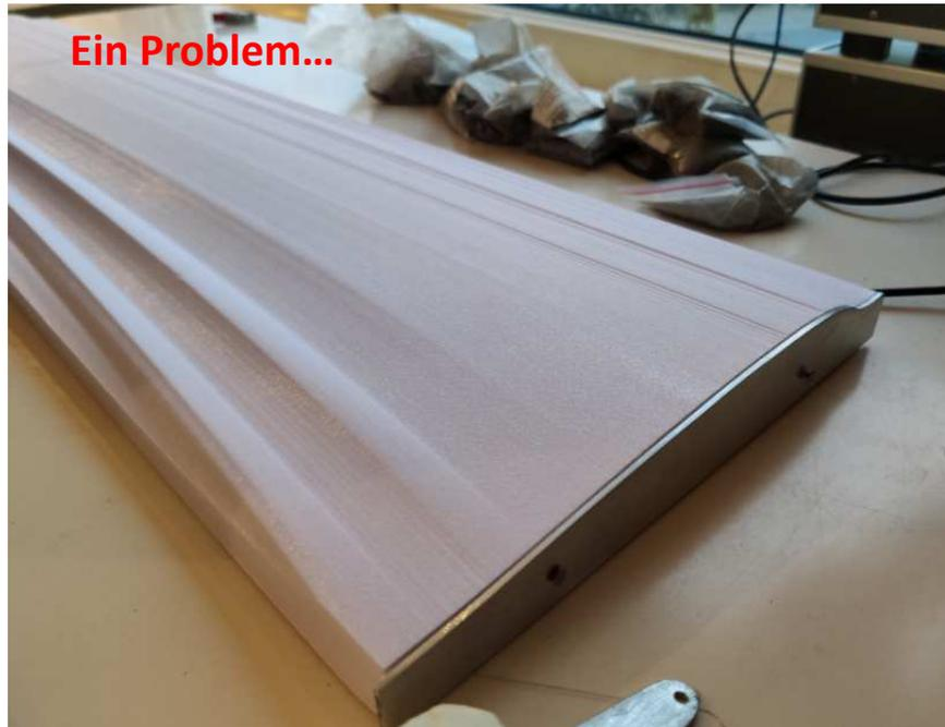
Verursacht durch die nicht ausreichende Spannung des Schneiddrahtes im Schneidbogen wandert der Draht nicht mit konstanter Geschwindigkeit durch das Material. Das Ergebnis ist ein unschönes Wellenmuster. Wir werden den Schneidbogen neu konstruieren, sodass wir dann mit einer höheren Drahtspannung und einem etwas größeren Drahtdurchmesser auf ein besseres Ergebnis hoffen.
