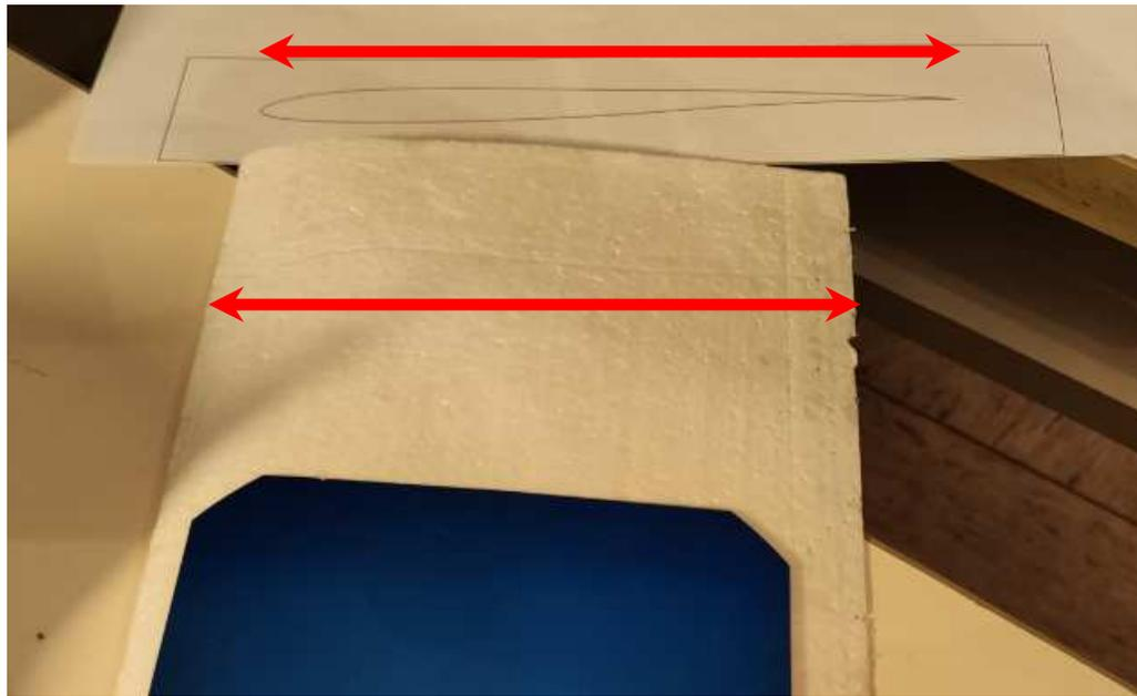
Durch die Dicke des Schneiddrahtes (0,2 mm) und den Verlust beim Schneiden wird der Flächenkern viel kleiner, als die erwartete Flächentiefe. Es fehlen ca. 3 cm. Die Schneidprofile müssen entsprechend korrigiert werden.
